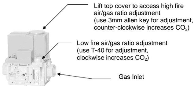
**Figure 10: DR2000 - 5000 1:1 Air/Gas Ratio Control Valve**
