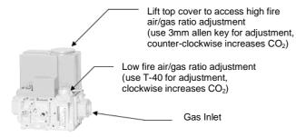
Figure 10: DR2000 - 5000 1:1 Air/Gas Ratio Control Valve
